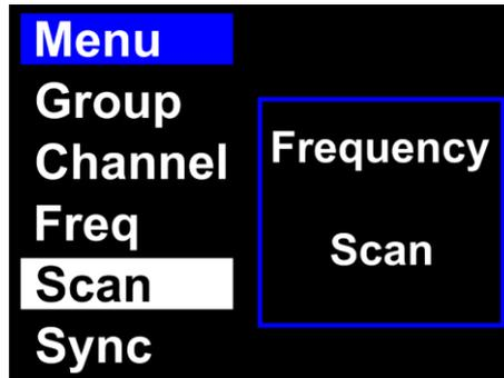
02) Drücken Sie auf den **Regler (02)**, um den gesamten Frequenzbereich (610-668 MHz) zu scannen. Der Vorgang kann bis zu 2 Minuten dauern. Nach dem Scan sehen Sie, welche Frequenzen bereits verwendet werden und welche noch frei sind.
