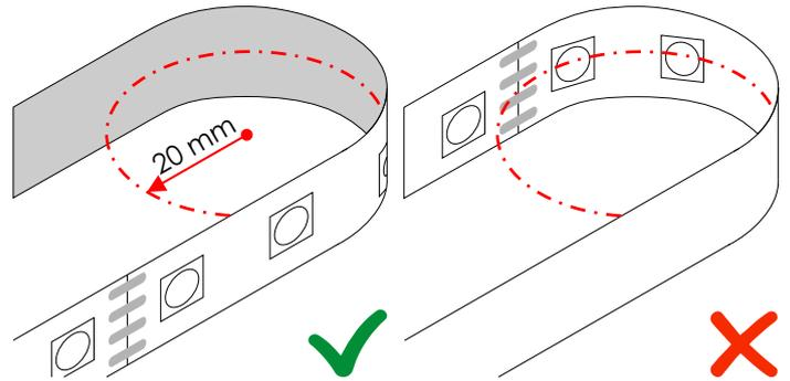
Der LED-Streifen kann nur entlang der vertikalen Achse gebogen werden. Der minimale Biegeradius beträgt 20 mm.
