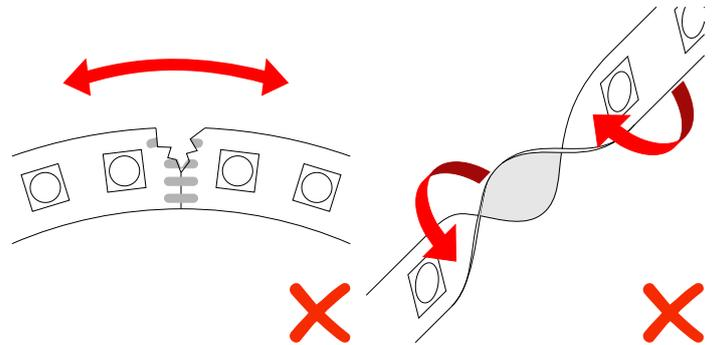
Biegen Sie den LED-Streifen nicht entlang der horizontalen Achse.
