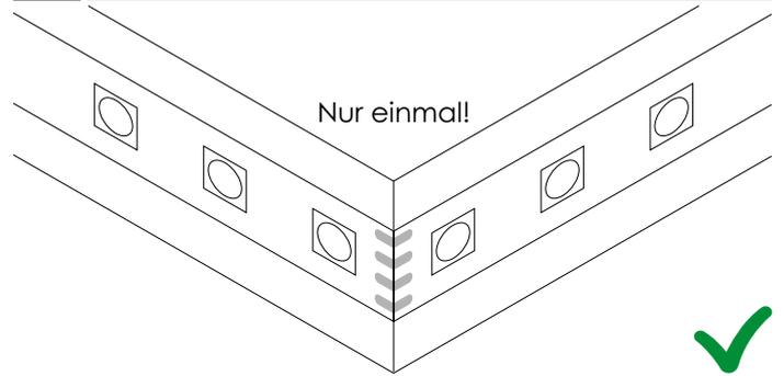
Knicken Sie den LED-Streifen an der Schnittlinie, um ihn an Ecken anzubringen. Knicken Sie den LED-Streifen nur einmal!
