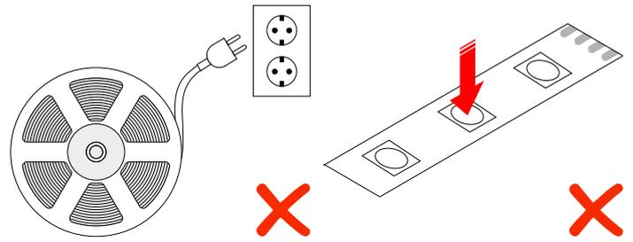
Schließen Sie den LED-Streifen nicht an die Stromversorgung an, wenn er sich auf der Rolle befindet oder fest aufgewickelt ist. Dadurch werden die LEDs beschädigt.
