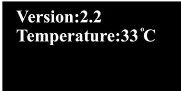
Unmittelbar danach wird auf dem Display der Startbildschirm (wenn das Gerät gesperrt ist) oder das Hauptmenü (wenn das Gerät entsperrt ist) angezeigt. Der Startbildschirm gibt Auskunft über die Betriebsmodi des Geräts, die Softwareversion, den DMX-Kanalmodus und die Temperatur der LEDs.
